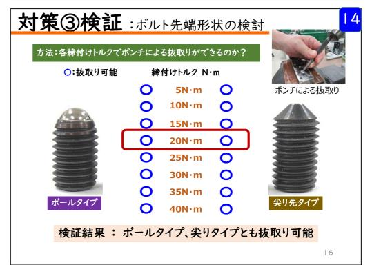
両タイプともに折損ボルトを固定でき良好だったので、さらに5 ニュートン刻みで締付け、ポンチによる折損ボルトの抜取りがで きるかどうか、ドリルによる下穴加工でも緩まないか、を検証し、 止めネジの締付けトルクを20ニュートン・メートルに決定しまし た。
