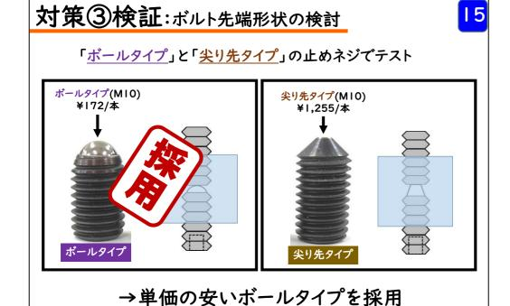
以上の検証作業により、ボールタイプと尖り先タイプの機能に差がないことがわかりましたので、最終的にはコスト面での比較を 行い、単価の安いボールタイプを採用することにしました。
