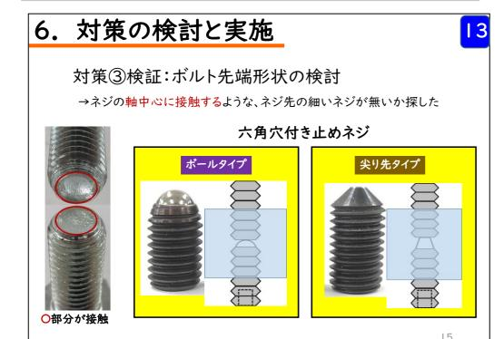
対策②の失敗の要因について掘り下げてみると、ボルト先端の 接触面積が大きいため、折損ボルト側も同時に回転してしまうと 推察できました。そこで、接触面積の小さい、ボールタイプと、尖 り先タイプの止めネジを使い再度検証してみました。
